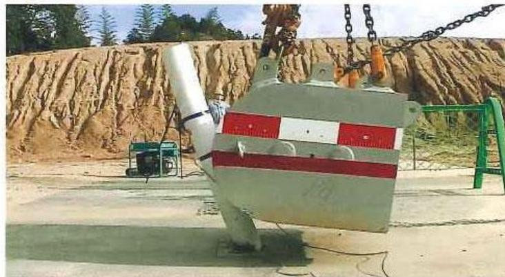
**衝突条件** 車両衝突を再現した2トンの錘
