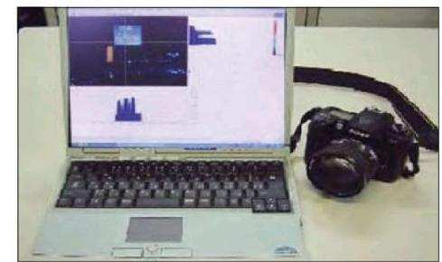
反射輝度測定用デジタルカメラ及びPC
