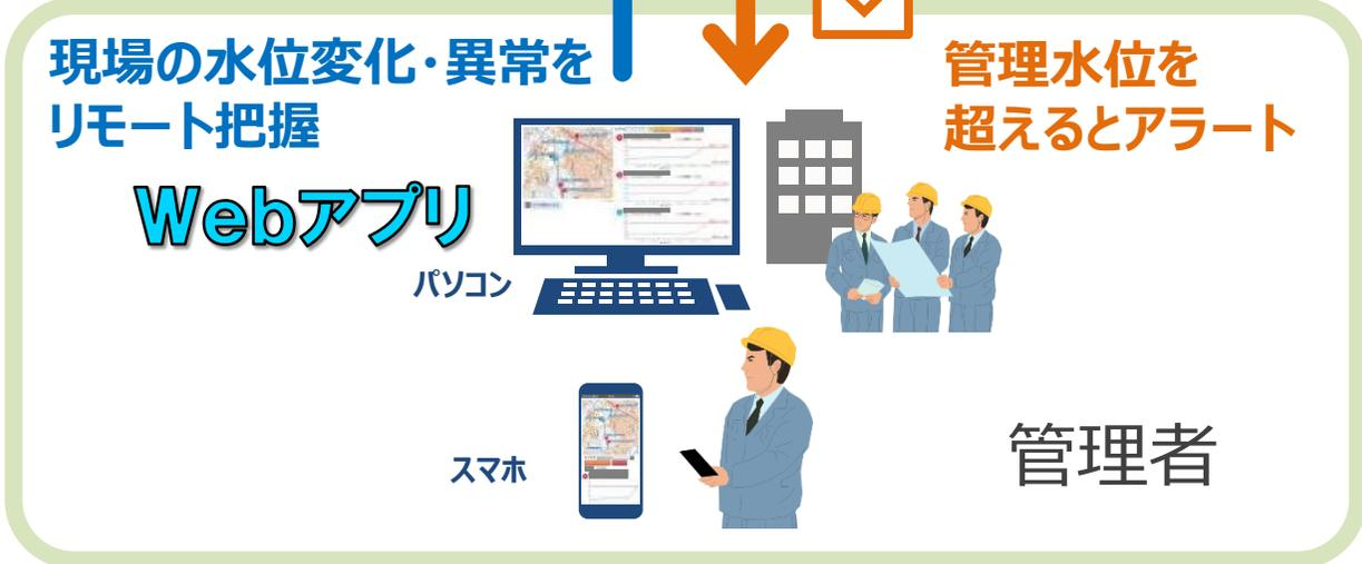
Webアプリ上で水位監視、管理水位を超えるとアラートメール形式で管理者に通達される簡易IoT水位モニタリングシステム
